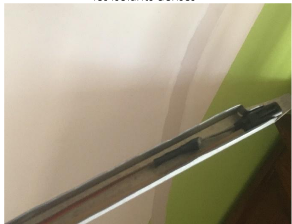
Outil « fourre-sonde » pour positionner le capteur contre le mur pierre
