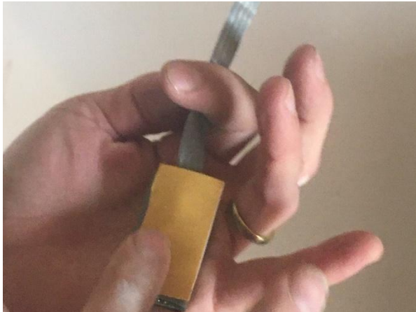
La sonde TH3 est collée à l'adhésif double-face dans la lame d'air
