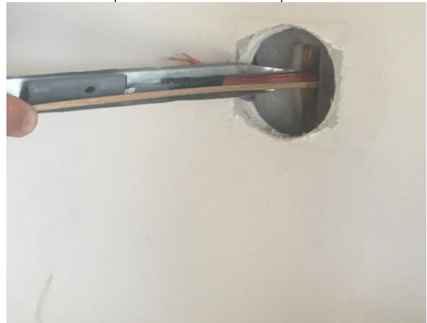
Libération de la tête de la sonde. On s'assure que la sonde reste en place et que l'isolant reprend sa place au retrait du fourre-sonde
